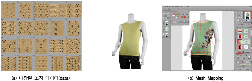
<그림 2> SDS-ONE의 내장된 데이터(data)와 Mesh Mapping
