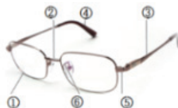
<그림 26> 안경테의 구조 ① 림(rim), ② 브릿지(bridge), ③ 템플(temple), ④ 팁(tip), ⑤ 앤드피스(end piece), ⑥ 노즈 패드(nose pad)
